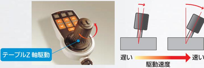
ジョイスティックによりテーブル X/Y/Z 方向の駆動を操作。倒し込み量によって駆動速度が変化し、マニュアル操作の感覚に近い、繊細な操作を実現。
